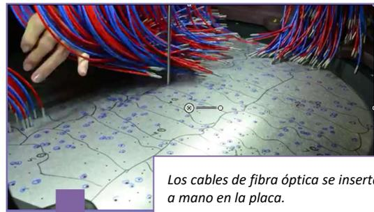
Los cables de fibra óptica se insertan a mano en la placa.
