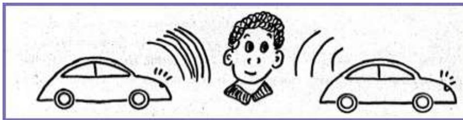
El mismo efecto se ocurre con ondas de luz. Si un objeto se mueve hacia ti, las ondas de luz que el objeto da aparecen corta, así que la luz va a convertirse más azul. Si un objeto se mueve lejos de ti, las ondas de luz aparecen estirado, están convertirse más rojo. Los grados de corrimiento al rojo o azul son directamente relacionado con la velocidad del objeto en la dirección que miramos.
