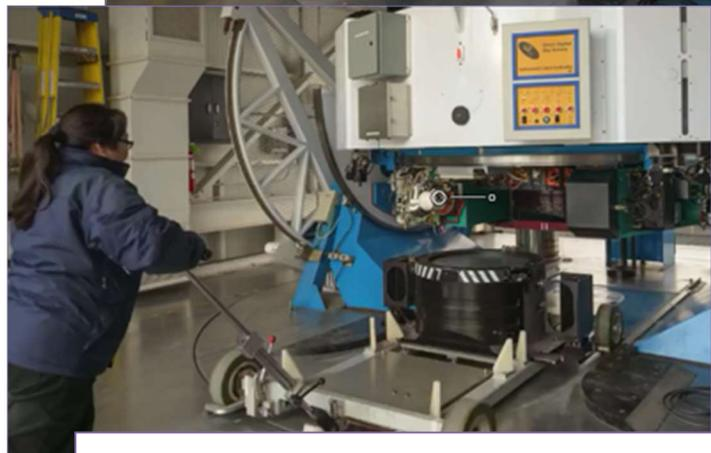
Karen Kinemuchi carga el cartucho de placas de aluminio y placas de fibra óptica en el espectrógrafo que está conectado en la parte trasera del telescopio.
